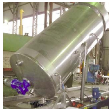
Digestore Modulare Mobile
