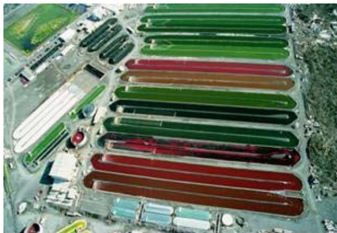
Fig. 1 – Impianto Cyanotech (Hawaii): Raceways di Haematococcus (fase verde e fase rossa)
